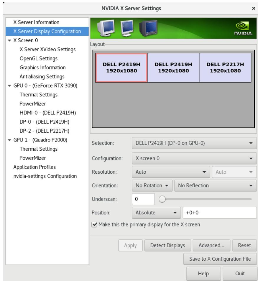
レイアウト・ウィンドウでは検出された3つのディスプレイのグラフィカル表示が見れます。全てのモニターが最初の起動でnvidia-xconfigによって既に構成された事に注意して下さい。
