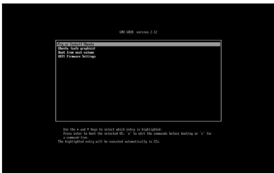
インストールを進めるには強調表示されたTry or Install UbuntuでEnterを押して下さい。
