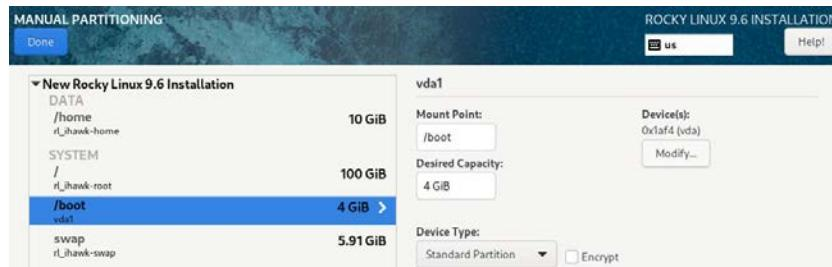
14. 次にswapパーティションを選択し、Desired Capacityを以下の表で推奨するサイズに合うよう変更してUpdate Settingsボタンを押下して下さい。
