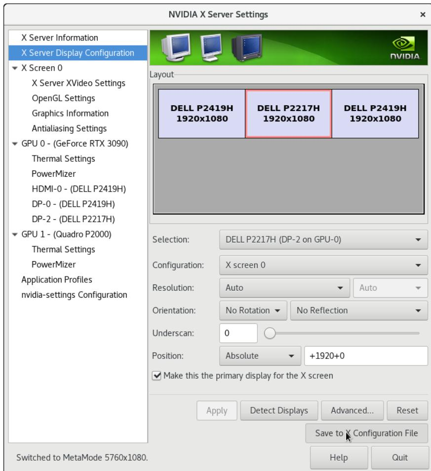
**Save to X Configuration** のラベルの付いたダイアログが表示されます。
