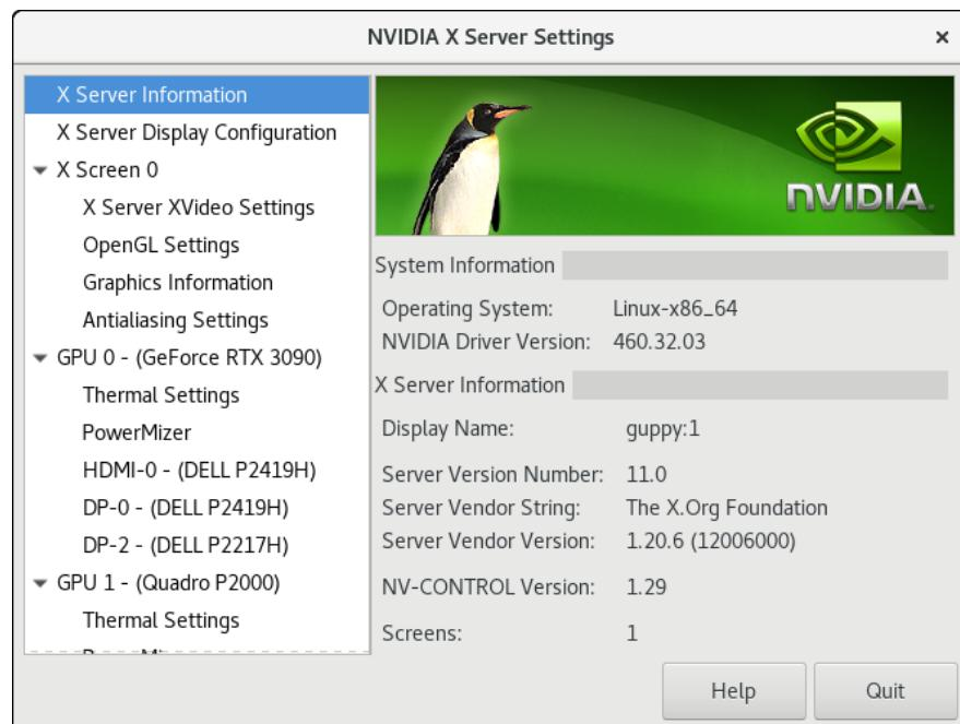
画面の左側にシステム上に2枚のNVIDIAカード(GPU0とGPU1)があることが確認できます。3つのモニター全てがGPU0カードに接続されています。右側にはNVIDIA ドライバー・バージョンを含むシステムの情報があります。
