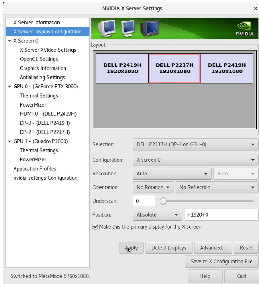
**Apply**をクリックすると変更がすぐに有効となります。デスクトップはプライマリとして選択されたディスプレイ(本例ではDELL P2217H)上に表示されます。
