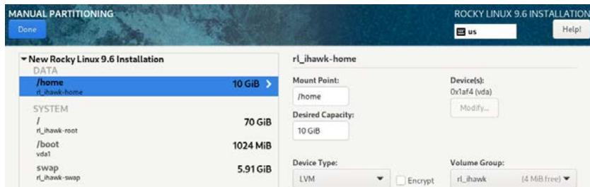
12. 次に / パーティションを選択し、Desired Capacity を 100GiB に変更して Update Settings ボタンを押下して下さい。
