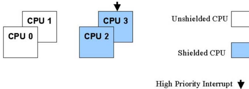
このアプローチの利点は、(CPU3上で動作する)割り込みルーチンとシブリングCPU上の高優先度タスク (CPU2上で動作する割り込み待ちプログラム)の実行との間で僅かながらの並列処理を提供することです。割り込みルーチンがCPU3上で実行している唯一のコードであるため、この割り込みルーチンは通常L1キャッシュに完全に保持され、そのコードはキャッシュの中に留まって、割り込みルーチンに対し最適な実行時間を提供します。その割り込みルーチンはシブリングCPU上の割り込み待ちタスクを起すためにプロセッサ間割り込みを送信する必要があるため、小さな代償を払うことにはなりません。この余分なオーバーヘッドは2  $\mu$  秒未満です。
