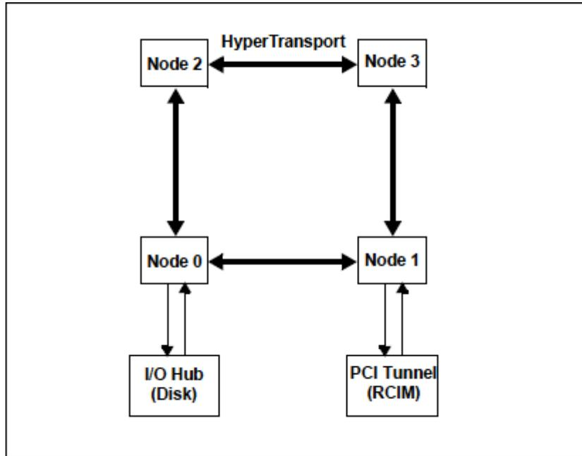
OpteronシステムでのI/Oデバイスへのアクセスも同様に完全な対象型ではありません。I/O HubとPCI Tunnelは、システム内の特定ノードに直結しています。図2-7の中でI/O Hub はNode 0に接続し、PCI Tunnel はNode 1 に接続しています。試験においてプログラム化されたI/Oの時間は、プログラム化したI/Oを実行しているプログラムがデバイスが存在するI/Oバスへ接続したノード上で実行している時、最速かつよりデターミニスティックであることを示しました。I/O性能に対するこの影響は、ほかのプログラムがI/Oまたは非ローカルメモリ操作を実行中であるため、HyperTransport相互接続により競合するときに特に目立ちます。
