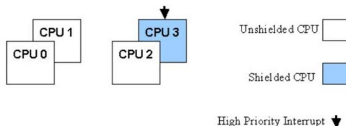
このサンプルでは、CPU3はシールドされ、高優先度の割り込みとその割り込みに応答するプログラムだけの実行を許可しています。CPU2はシールドされていないために通常の利用が可能、つまり特定のタスクを実行するために構成されています。プリエンブションや割り込みブロックが無効の時、CPU3上で実行中の高優先度割り込みやタスクには影響がないため、CPU2上で動作するタスクは直接割り込み応答時間へ影響を与えることはありません。しかし、チップのリソースレベルではCPU3上での実行のデターミニズムには影響を与える競合が存在します。その影響の度合いはアプリケーションにとっても依存します。
